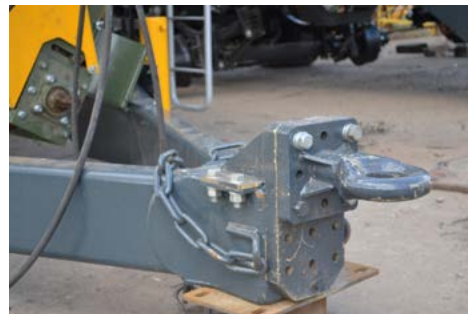
Адаптер для регулювання висоти причеплення під будь-який трактор
