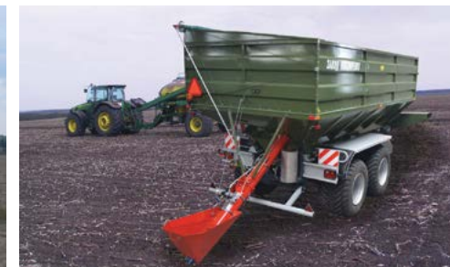
Завантажувальний шнек з протруювачем
