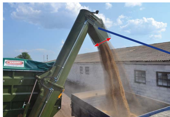
Гідравлічний козирок шнека (опція) направляє потік зерна. Рівномірно завантажує автомобіль під лівий і правий борт
