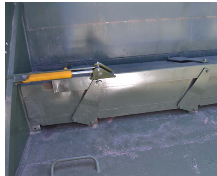
Гідравлічно відкриваюча шиберна заслінка. Подає зерно в шнековий транспортер.
