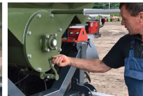
Гвинтовий механізм відкриття очисних заслінок горизонтального шнека
