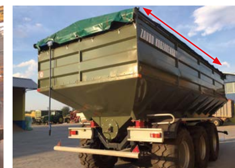
Здвижна - розкладається вручну через редуктор
