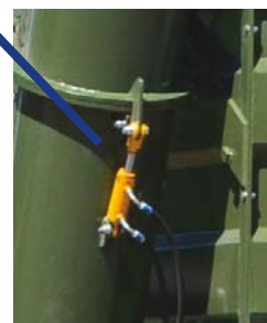
Гідравлічний замок фіксатор двох частин шнека.
