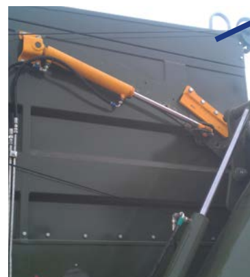
Гідравлічна зміна кута вивантажувального шнека (опція)
